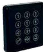
ACG5522 Tastiera filare Nero, Antigraffio, con TOUCH capacitivo, retroilluminata, IP65 72x72x11,6 mm
